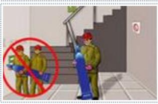
Перемещать баллоны в пределах рабочего места разрешается кантованием в слегка наклоненном положении. Запрещено переносить баллоны вручную
