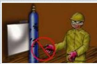
Спецодежда сварщика должна быть чистой, без следов масла и жиров. Попадание масла на штуцер баллона с кислородом может вызвать взрыв или возгорание
