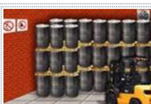
В механизированных складах допускается хранение барабанов с карбидом кальция в три яруса при вертикальном положении.
