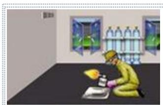
Помещения, в которых возможно скопление ГГ и ЛВЖ, перед началом огневых работ должны быть проветрены.
